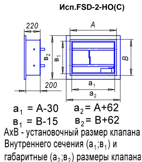
Рис.1. Установочные, габаритные и размеры внутреннего сечения клапана.
