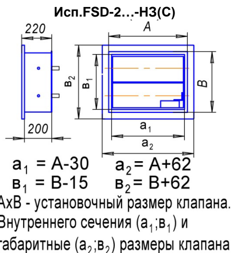
Рис.1. Установочные, габаритные и размеры внутреннего сечения клапана.
